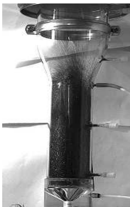
Figure 48- Structure d'écoulement des particules solides dans la colonne transparente
