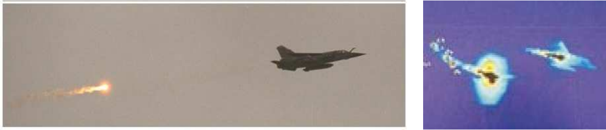
Fig. 1.1 : Prises de vue d'un aéronef larguant un leurre IR. Photographie prise dans le domaine du spectre du rayonnement visible (à gauche) et infrarouge (à droite).
