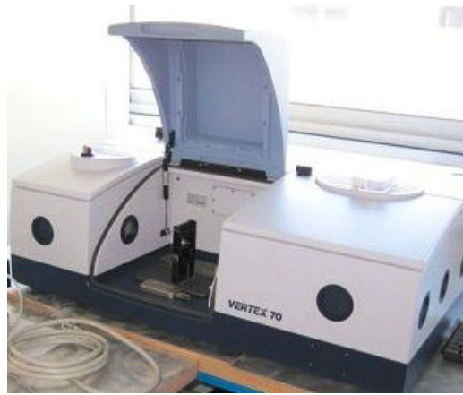
FIGURE A.2 – Spectromètre IRTF configuré en transmission
