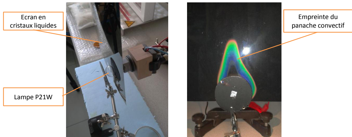
FIGURE 2.5 – Mise en évidence qualitative de la convection autour du bulbe
