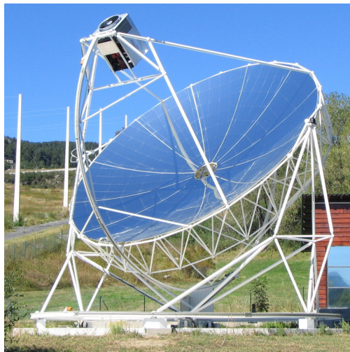
(f) Concentrateur Dish avec moteur Stirling au foyer, en exposition au four solaire d'Odeillo. Source : Wikimedia Commons
