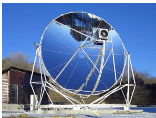
(b) Parabole à Odeillo (France) : concentrateur ponctuel à un miroir
