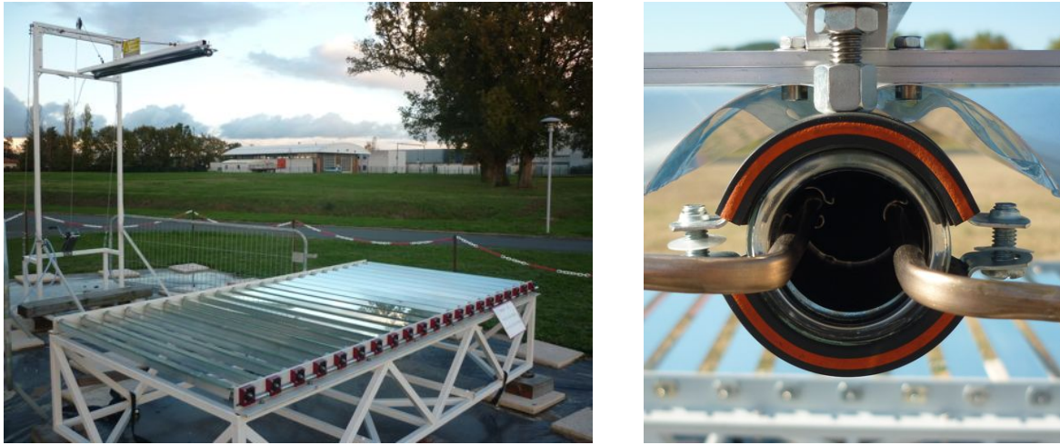
FIGURE 6.3 – Prototype construit à Albi : vue générale (à gauche) et détail du récepteur (à droite)
